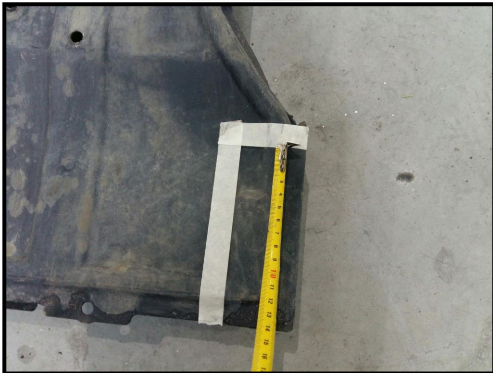
Przyciąć lewy róg dolnej osłony jak pokazano na zdjęciach (14cm x 5,5cm). / Cut the left corner of the lower plastic shield as shown on pictures (14cm x 5,5cm)
